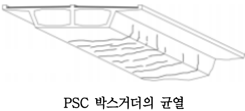
【그림 3.2.6】 프리스트레스트 거더별 조사부위 및 균열
